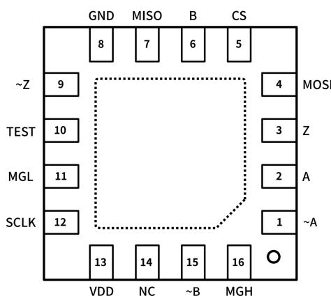
图 3: QFN-16L 3mmx3mm
