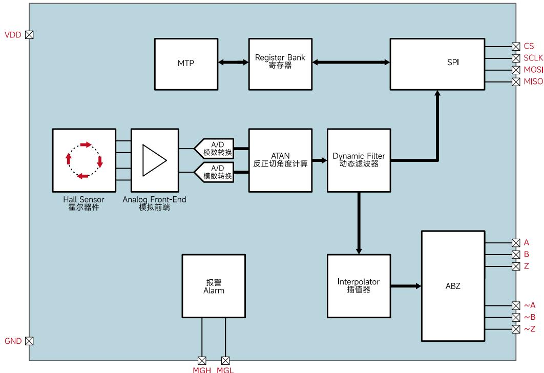
KTH7814 是一款霍尔角度编码器，它集成了霍尔器件、数模转换器（ADC）和各种模块，用于精确测量角度并输出相应的数字信号。
