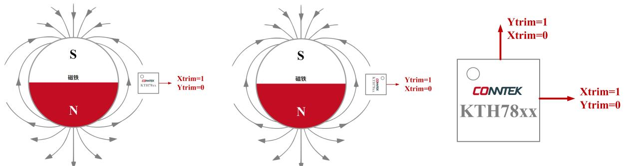
具体的灵敏度减小程度由 GAINtrim(7:0) 参数决定，它是一个 8 位整数，取值范围从 0 到 255。较小的 GAINtrim 值代表较小的灵敏度减小值，正常情况下径向和切向磁场强度相同，磁场比  $\mu$  为 1，则不需要修正，GAINtrim(7:0) 参数设为 0。若离轴应用时芯片放在磁铁的正右边时，径向约为切向磁场强度的 2 倍即  $\mu$  为 2，如右表 13 GAINtrim(7:0) 经验值可设为 128。
