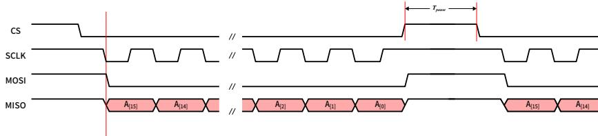
图中显示了主设备和 KTH7814 角度传感器之间的连接，并且展示了数据位的传输和接收顺序。注意：两次通信之间的时间间隔  $T_{pause}$  须大于 150ns。
