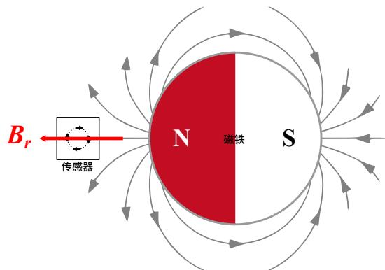
为了更好地校准传感器并检测磁铁位置，KTH7814 引入了磁场比  $\mu$  的概念，它是一个重要的参数，用于描述磁场强度与实际磁铁位置之间的关系。磁场比  $\mu$  表示最大径向磁场  $B_r$  和最大切向磁场  $B_t$  之间的比值，计算公式如下：
